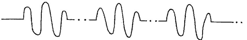
Die drei Parameter des Signals sind: die Anzahl der Töne (Ausdruck < Tonanzahl >), die Frequenz des Tones (Ausdruck < Tonhöhe >). Die Anzahl der Töne und damit der Wert des numerischen Ausdrucks < Tonanzahl > darf variieren zwischen 0 und 65 535.
